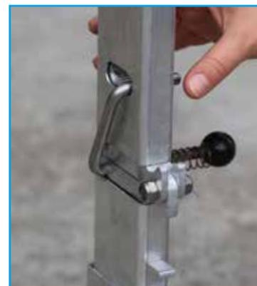
4. Enclencher la manette dans le logement en relâchant la poignée (le logement est muni de crans) de verrouillage, afin de verrouiller complètement le montant, puis pousser la manette côté extérieur jusqu'au dernier cran. Le système est alors entièrement verrouillé.
