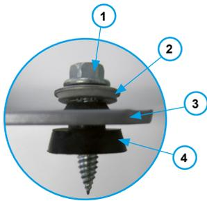
Alors qu'une vis autoforeuse standard évacue la matière du perçage en copeaux, la vis Drillnox DBS2 6x25 refoule la matière vers l'intérieur en formant un bourrelet, ce qui augmente la longueur d'implantation. Le couple de forage reste ainsi élevé même dans les petites épaisseurs (> 5 N.m contre une moyenne de 1.5 N.m pour les vis autoforeuses classiques). **Pour une fixation plus sûre, nous recommandons l'option «Douille Limiteur de Couple DB CONTROL 5N.m» (cf options).**
